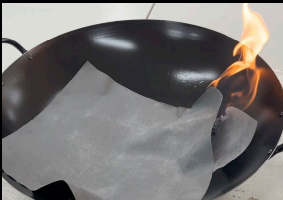
酸素供給遮断・燃焼抑制 気化した消火剤が酸素供給を遮断し、燃焼を抑制
