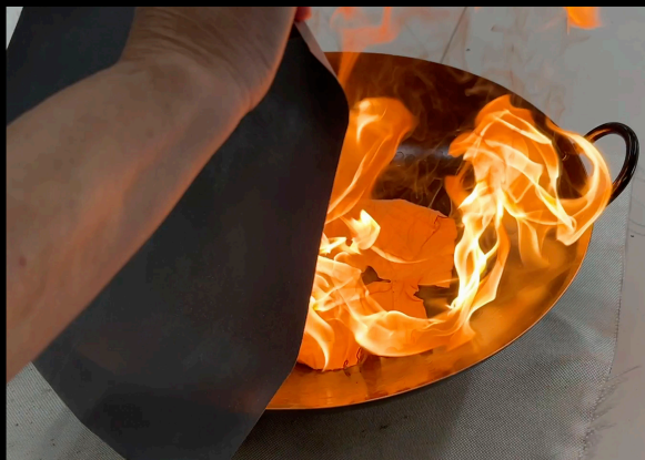
消火クロスを被せる 105℃の熱でマイクロカプセルから消火剤が自動散布
